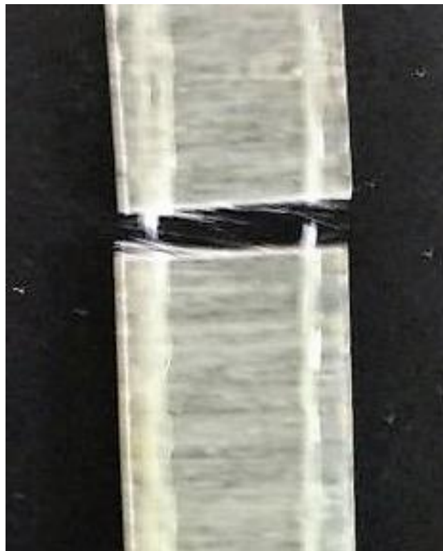
Figura 25: Falha no corpo de prova a 90° no ensaio de tração.
