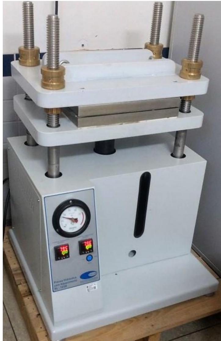
Figura 8: Prensa hidráulica com controle de temperatura utilizada.
