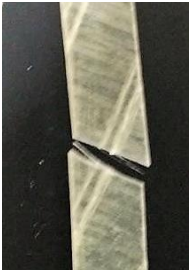
Figura 22: Falha no corpo de prova a 45^\circ no ensaio de tração.
