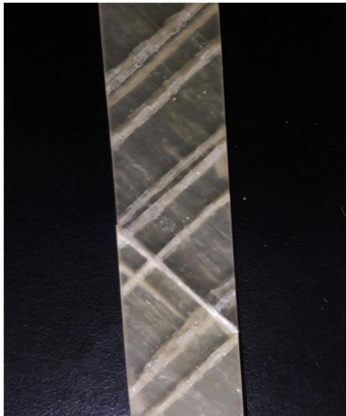
Figura 29: Falha no corpo de prova a 45° no ensaio de flexão.
