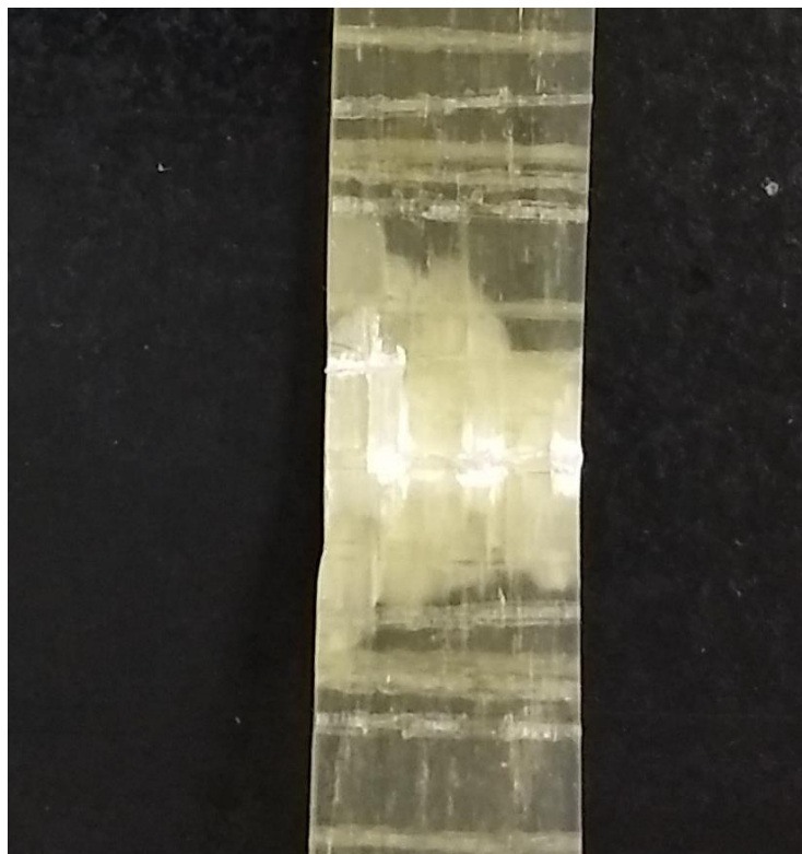
Figura 27: Falha no corpo de prova a 0^\circ no ensaio de flexão.
