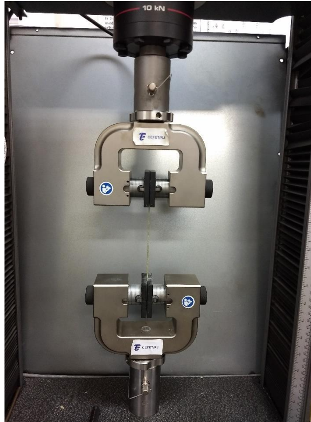
Figura 13: Posicionamento do corpo de prova na máquina de tração.
